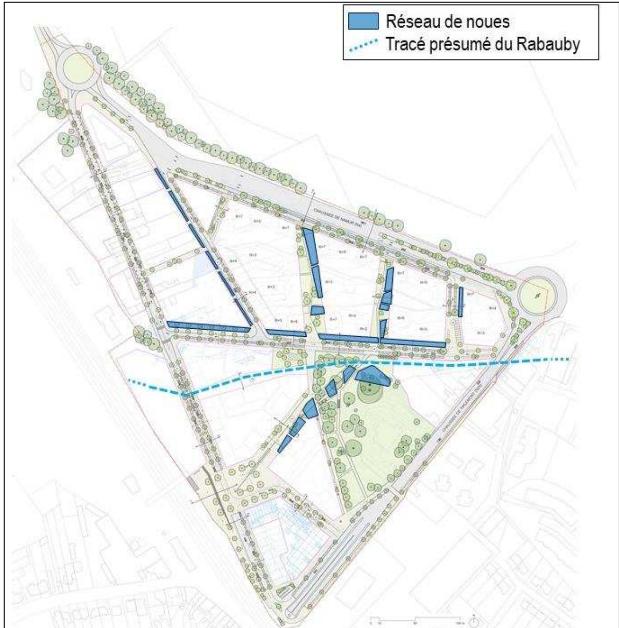
Figure 20 : Schéma de principe de gestion des eaux (JNC International, 2018)
