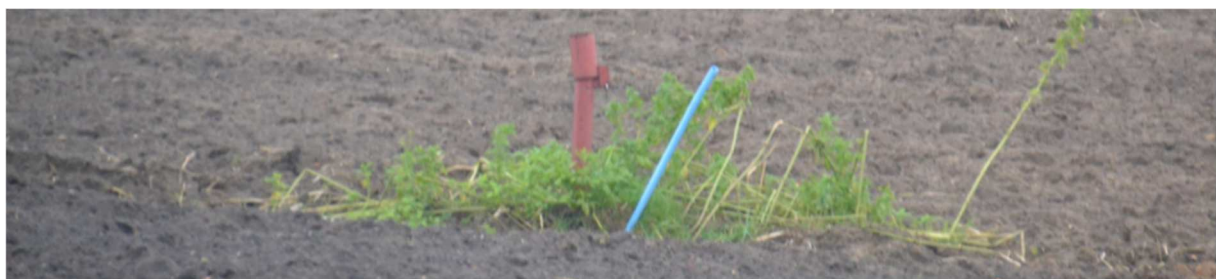
Figure 109 : Piézomètre situé dans la partie est de l'avant-projet de PRU (ARIES 2018)
