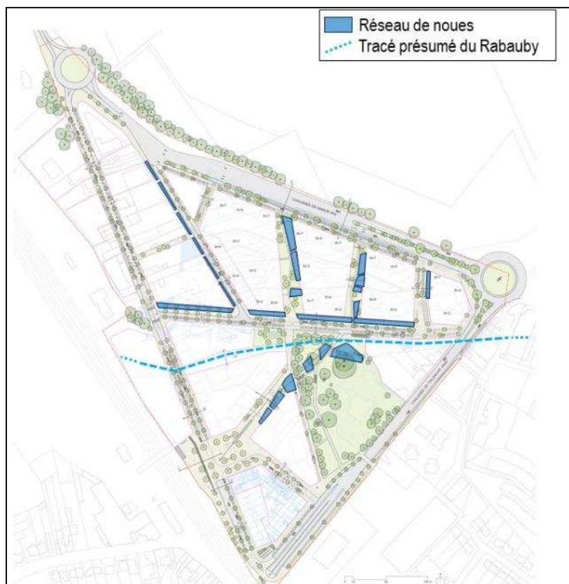
Figure 201 : Schéma de principe de localisation des noues (JNC, 2018)
