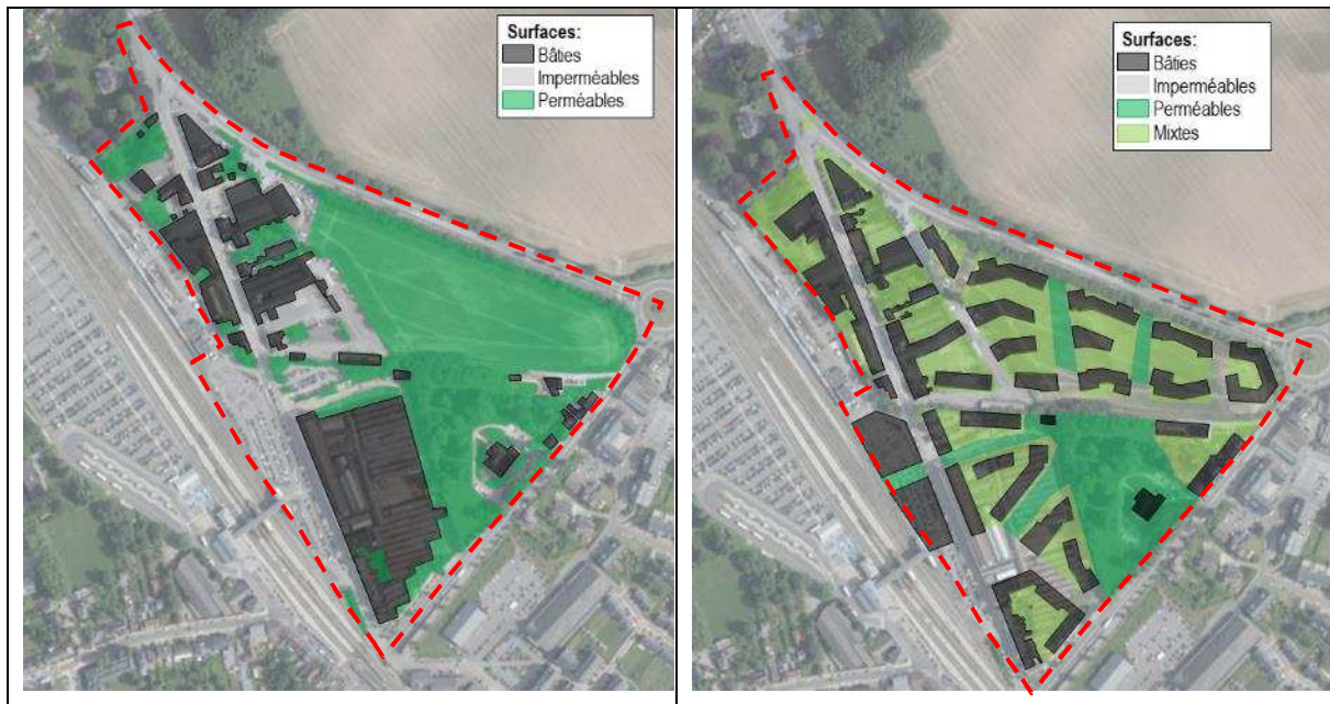
Figure 208 : Imperméabilisation du périmètre de remembrement urbain en situation existante et projetée (ARIES 2018)
